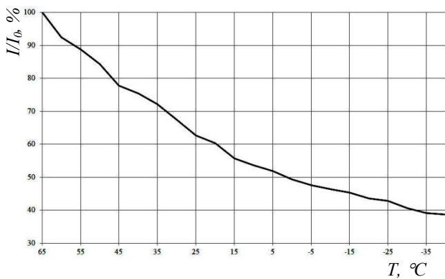
Рис. 5. Снижение текучести гидравлического масла при замораживании
