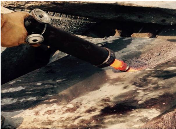
Рис. 9. Процесс работы терморезака TRV-12 M1 с насадкой
