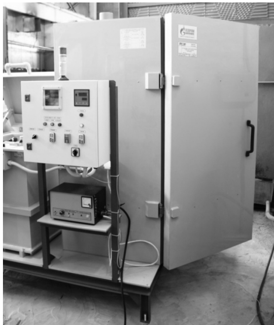
Рис. 8. Автоматизированная установка комбинированной очистки (шумоизолированный шкаф с ультразвуковым устройством открыт)
