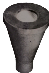
Рис. 1. Поковка, изготовленная холодным выдавливанием (материал – сталь 20 (ГОСТ 1050-74))
