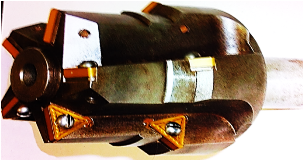
Рис. 2. Реальная модель комбинированного зенкера для обработки цилиндрического и конического отверстий
