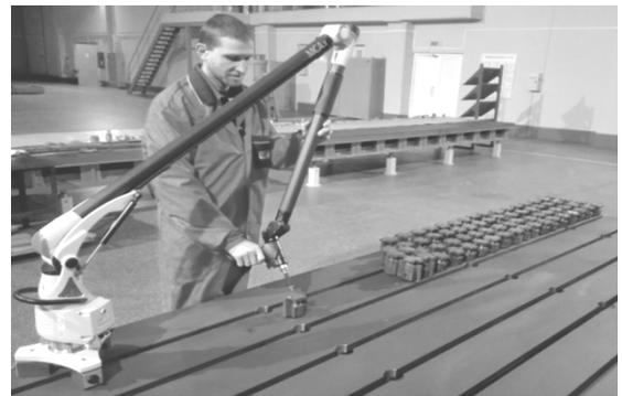
Рис. 5. Лазерное сканирование пакета лопаток с помощью координатно-измерительной руки NikonMetrology MCAx40+
