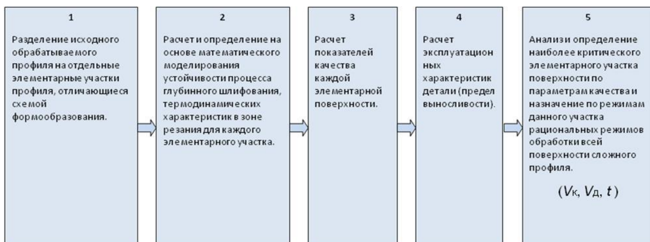
Рис. 3. Этапы назначения рациональных режимов глубинного шлифования поверхностей сложного профиля
