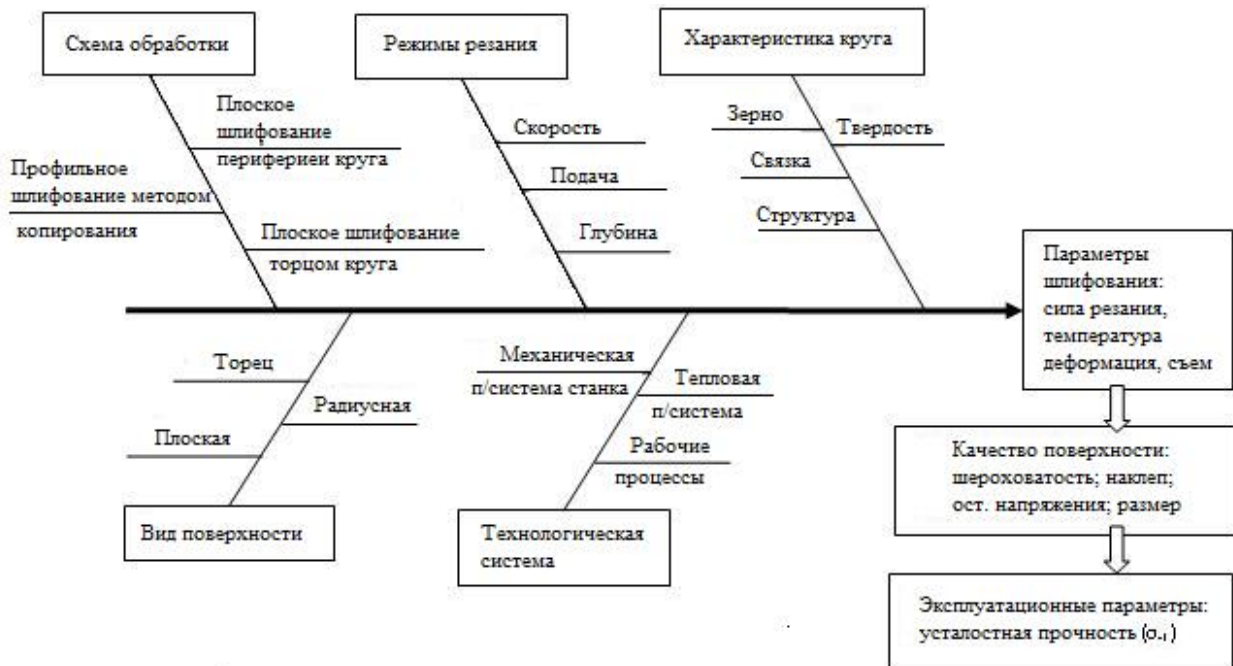
Рис. 4. Причинно-следственные связи условий обработки и качества поверхностного слоя при глубинном шлифовании
