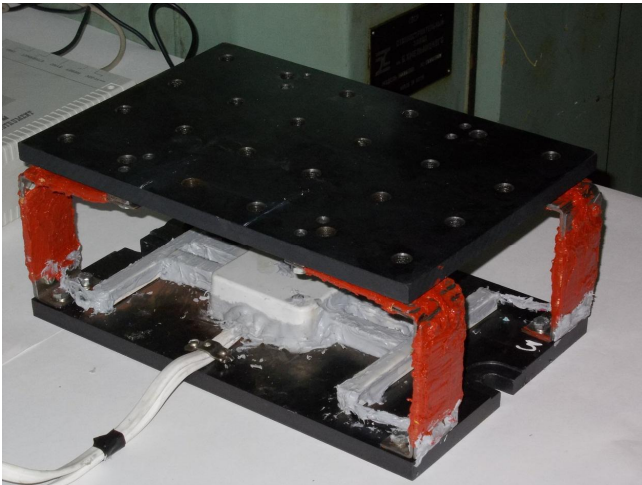
Рис. 4. Динамометр для измерения сил резания при шлифовании
