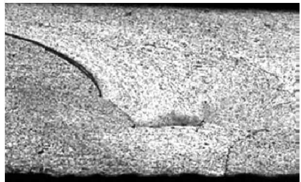
Рис. 3. Поперечный макрошлиф сварного соединения с несплавлением в корневой части шва (×25), полученного СТП на сплаве АМг5М толщиной 4 мм
