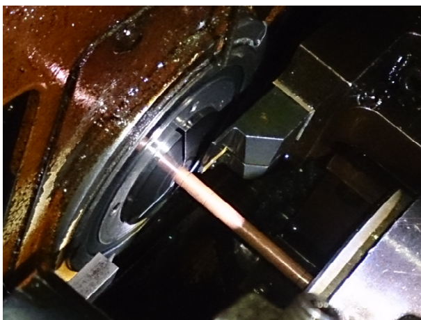
Рис. 2. Экспериментальное исследование двурезцового точения фасонных поверхностей
