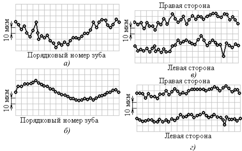
Рис. 2. Радиальное биение зубчатого венца и разность соседних основных шагов после фрезерования зубчатого колеса (а и в соответственно) и после шевингования шевером первого типа (б и г соответственно)
