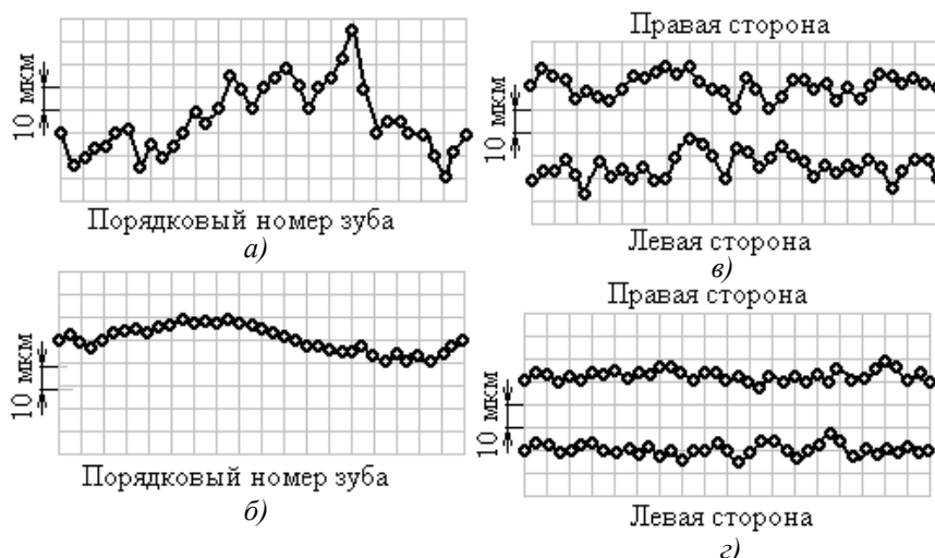
Рис. 5. Радиальное биение зубчатого венца и разность соседних основных шагов после фрезерования зубчатого колеса (а и б соответственно) и после шевингования шевром второго типа (б и г соответственно)
