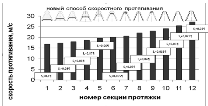
Рис. 1. Изменение скорости резания в процессе протягивания елочных пазов в дисках турбины из сплава ЭИ787ВД многосекционными твердосплавными протяжками
