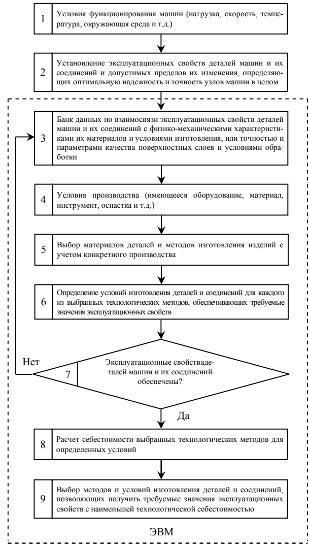
Рис. 3. Структурная схема одноступенчатого решения конструкторско-технологической задачи обеспечения качества проектируемой машины
