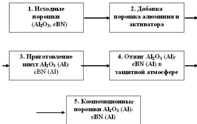
Рис. 6. Схема получения модификаторов алюминиевых сплавов на основе Al_2O_3 и cBN
