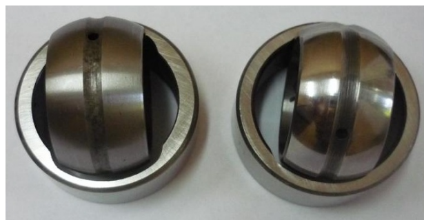
Рис. 1. Сферические поверхности подшипников скольжения ШС30, обработанные ФПУ (слева) и изготовленные по заводской технологии (справа)
