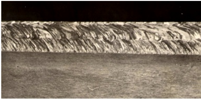
Рис. 6. Продольный макрошлиф зоны наплавки
