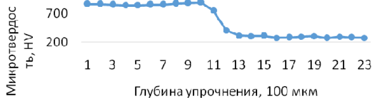
Рис.7. Микротвердость оптимального образца, полученного на следующем режиме: скорость обработки 25 мм/с; мощность лазерного излучения 5 кВт; ширина обработки 10 мм; плотность мощности 21 МВт/м 2
