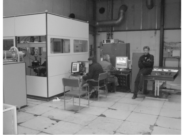
Рис. 1. Комплекс СЛС, (справа – технологическая кабина с работающими операторами; слева – выходящая часть лазера «Гибрид»)
