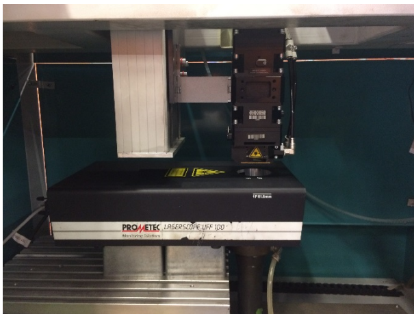
Рис. 8. Станок для прецизионной лазерной обработки с интегрированной оптической системой для лазерной полировки
