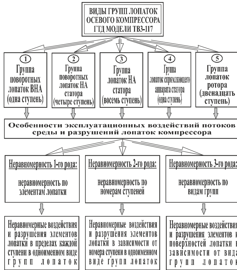
Рис. 2. Виды групп лопаток осевого компрессора ГТД модели ТВ3-117 и особенности их разрушений
